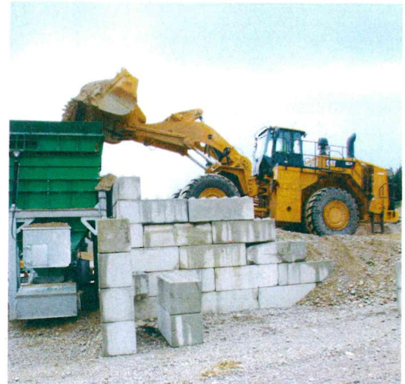
Der Radlader ist ein Schlüsselgerät der gesamten Produktion, der über einen Trichter die Förderbänder beschickt. Fotos: Zeppelin
