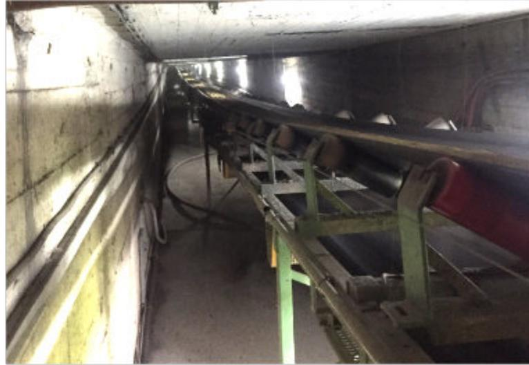
Einzigartig ist die in den 60-er Jahren gebaute **unterirdische Förderbandtrasse** vom Gewinnungsgebiet Forst Kasten zu unserem Werk in Gräfelfing. Dadurch ist ein Rohkiestransport von Forst Kasten **ohne** LKW-Verkehr zur Aufbereitungsanlage nach Gräfelfing möglich, also weitgehend umweltverträglich.
