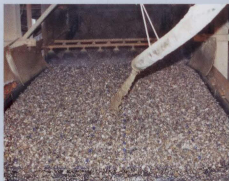
Siebmaschine mit Bebrausung von Rundkies
