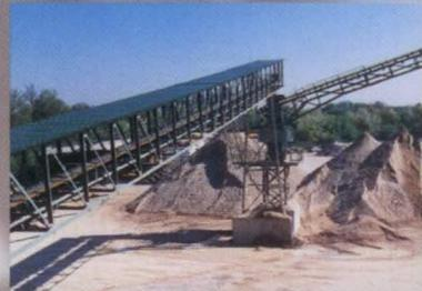
Nach der Reinigung folgt das Trennen des Materials nach Größen - dies geschieht durch spezielle Siebe, erst dann kommen die verschiedenen Fraktionen über Förderbänder auf Halde oder in Vorratssilos.
